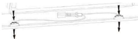
Desconectar el cable de luz y retirar la sujeción de las bombillas y el cable de la clavija. Importante: no es posible sustituir las bombillas de forma individual, habrá que sacar obligatoriamente todas las bombillas, la sujeción de las mismas y el cableado como un todo. (LED light: MAX 1.5W)
