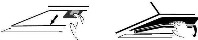
Conectar el filtro de carbono activado en la unidad y girar en el sentido de las agujas del reloj. Repetir en el otro lado.
