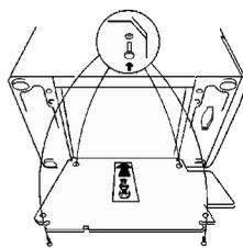
• Posicione la lámina de protección como se muestra en la figura.
