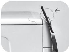
Si se desconoce la posición de la antena NFC, se debe mover ligeramente el teléfono en forma circular sobre el logotipo de Smart Touch hasta que la App confirme la conexión. Para que la transferencia de datos sea exitosa, es esencial **MANTENER EL SMARTPHONE EN EL PANEL DE MANDOS DURANTE LOS SEGUNDOS QUE REQUIERE EL PROCEDIMIENTO**. Un mensaje en el dispositivo informará del éxito de la operación e indica el momento en el que se puede alejar el Smartphone.
