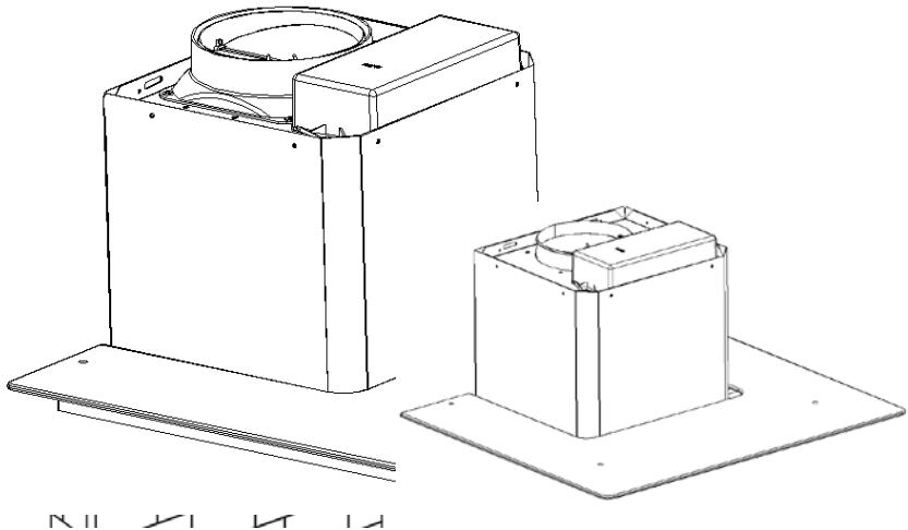
5. Befestigen Sie den Ein-Weg-Ventil um den Luftauslass der Dunstabzugshaube. Dann wie unten angezeigt den Abluftschlauch am Ein-Weg-Ventil der Haube befestigen.
