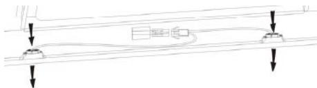
Desligue o ponto de luz e elimine os porta-lâmpadas, os casquinhos, retirando-os da chaminé. Importante: não é possível substituir as lâmpadas individualmente, tem que adquirir o suporte para lâmpadas, o sistema de fixação e as lâmpadas, numa peça completa que existe disponível no mercado (Luz LED: G4, MAX 1.5W)
