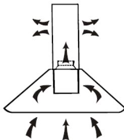
Pri unutarnjoj ventilaciji, za filtriranje dima i para koristi se aktivni ugljeni filter. Prije ugradnje aktivnog ugljenog filtera, prvo uklonite filter za masnoću. Pritisnite zasun i povucite filter prema dole.
