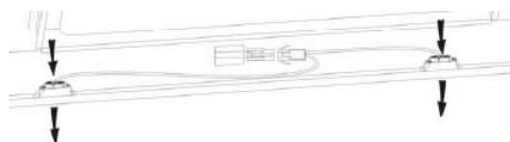
Odklopite žico za žarnico in z nape odklopite držalo žarnice in žico.
