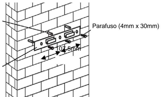
4. Levante e segure a chaminé e encaixe-a no suporte de parede depois deste ser colocado.
