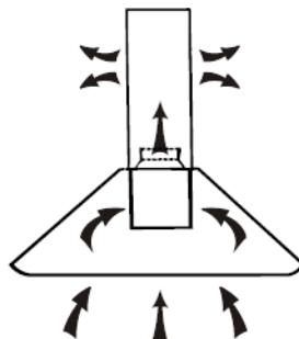
Les filtres à charbon actif sont utilisés pour absorber les odeurs.
