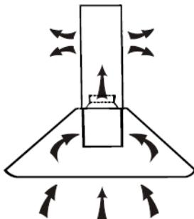
Μπορείτε να χρησιμοποιήσετε το φίλτρο ενεργού άνθρακα για να περιορίσετε τις μυρωδιές. Για να τοποθετήσετε το φίλτρο ενεργού άνθρακα πρέπει να αφαιρέσετε πρώτα το φίλτρο κατακράτησης λίπους πιέζοντας το γάντζο στερέωσης.
