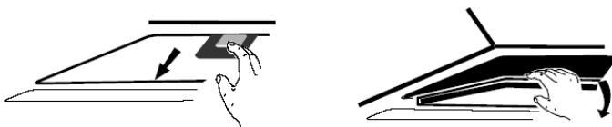
Conectar el filtro de carbono activado en la unidad y girar en el sentido de las agujas del reloj. Repetir en el otro lado.
