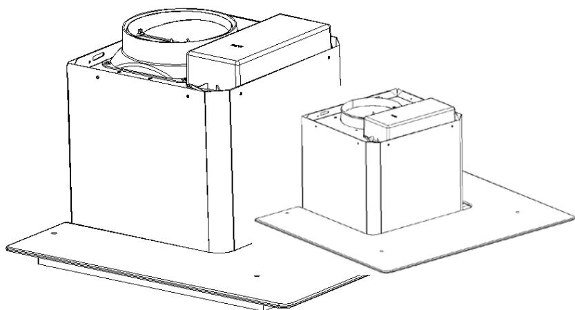
5. Fixe a válvula unidireccional para a saída de ar do exaustor. De seguida encaixe o tubo de saída do ar na válvula, como se exemplifica de seguida no desenho
