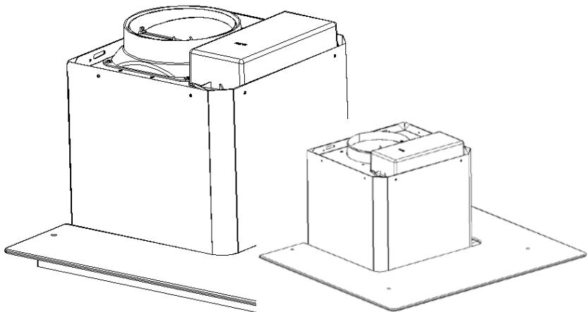
5. Fissare la valvola unidirezionale per l'uscita dell'aria della cappa. In seguito collegare il tubo di scarico sulla valvola unidirezionale come mostrato nella figura sottostante
