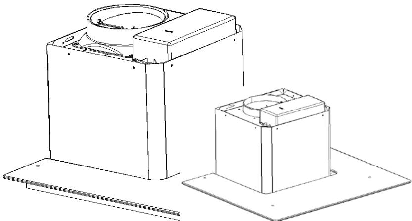
5. Na odprtino za izhod zraka iz nape namestite enosmerni ventil. Nato pa nanj namestite cev za odvod zraka, kot je to prikazano spodaj.
