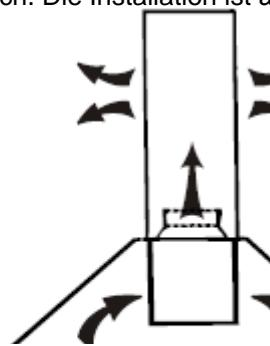
Aktivkohlefilter können eingesetzt werden um Gerüche aufzufangen. Um die Aktivkohlefilter zu installieren, sollten die Metallfettfilter zuerst gelöst werden. Drücken Sie die Verriegelung und ziehen ihn nach unten.
