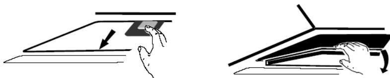
Inserire il filtro carbone attivo sul lato del motore e girare in senso orario. Ripetere la stessa cosa sull'altro lato.
