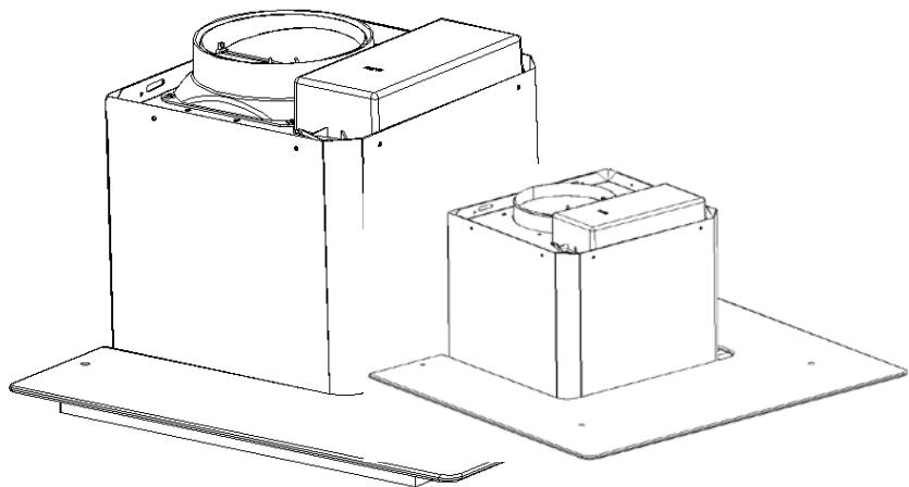
5. Bevestig de one-way klep aan de luchtauitgang van de afzuigkap. Maak de uitlaatbuis vast aan de one-way klep. (Zie afbeelding hieronder).
