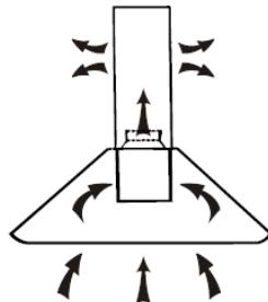
V tem primeru v napo vstavite filter z aktivnim oglem, ki zadrži vonjave. Najprej morate sneti filter za maščobe, nato pa lahko vstavite ogleni filter. Potisnite na zapah in potegnite filter za maščobe navzdol.
