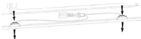
Odpojte bod spojení žárovky a vyjměte žárovku a vodiče z odsavače. Důležité: nelze vyměnit žárovky jednotlivě, musíte vyměnit žárovky, držáky a vodiče jako celek. (LED osvětlení: G4, MAX 1.5W).
