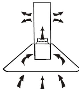
Puteti folosi filtru de carbon activ pentru evacuarea mirosurilor nedorite. Pentru a monta filtrul de carbon activ, trebuie mai întâi să scoateti filtrul pentru grăsime. Apăsați mânerul și trageți-l în jos.
