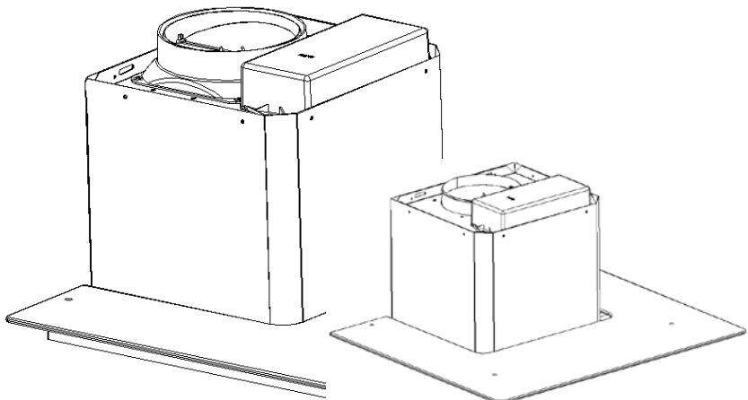
5. Zamocować zawór zwrotny na wylocie okapu a następnie założyć kanał wylotowy jak pokazano na rysunku.
